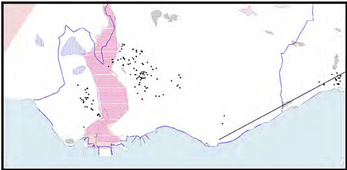
Şekil 140. Ağır ve orta hasarlı yapıların zemin değerlendirilmesi (Dilovası)
